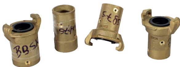
Conexiones para servicio de aire.
