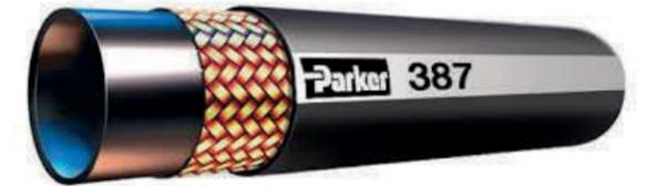
Manguera hidráulica de mediana presión de 1 a 2 mallas de alambre con presión de 3000 PSI, generalmente se utilizan en equipos de agricultura.
